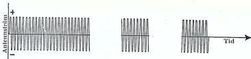
Bild 5. Den utsända vågen vid en telegrafstation med omodulerad sändning. (Tecknet d enligt morsystemet.)
