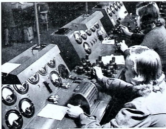
Bild 19. Sedan rören pumpats och katoderna aktiverats medelst s.k. inbränning och rören därefter socklats mätes rörens data upp. Detta sker i automatiska mätbord i vilka en rad olika arbetspunkter kontrolleras. Toleransgränser finns angivna på instrumentens skalor. (Philips).
