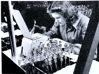
Bild 17. Rören inre monteras upp på glasfoten och de olika elektrodena punktsvetsas fast. (Philips).
