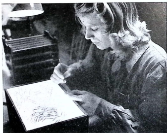
Bild 16. Radiorörets galler måste hålla noggranna mått och vara alldeles felritt. Här avsynas de färdiga gallren.
